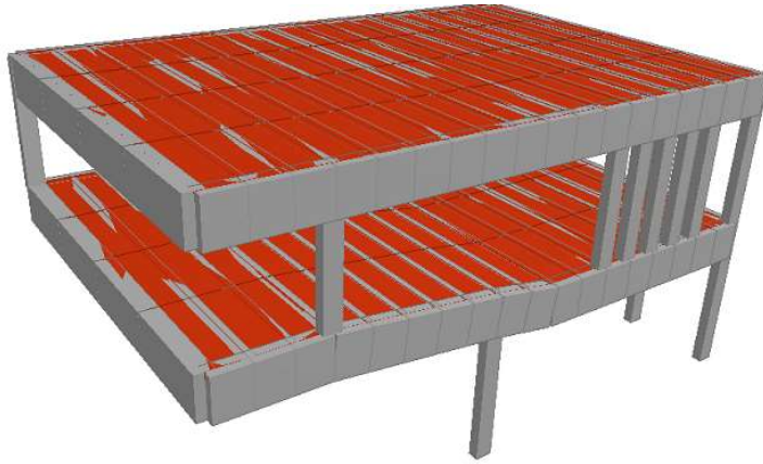
شكل /49/: تشققات عند نقاط تركيز الإجهادات بسبب تغير سلوك هيكل المدرج
